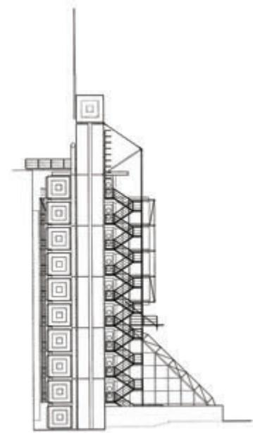
**La forme du bâtiment a été entièrement dictée par les restrictions de planification et les droits d'éclairage – son profil et sa superficie se conforment exactement aux cônes de lumière disponibles**
